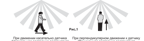
При движении касательно датчика (Нормальное расстояние восприятия) При перпендикулярном движении к датчику (Пониженное расстояние восприятия)
